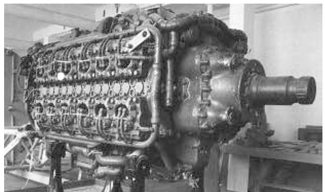
Napier Sabre de 24 cylindres en H de 2200 CV
